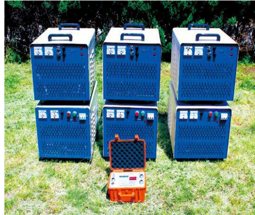
级联式大功率发射系统
