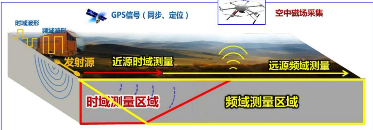
本系统利用电磁波在地下的传播特性获取地下电性结构，具有测量精度高、稳定性好等优点，是最有效的地球物理探测系统之一。系统首次提出了地、空协同时频域电磁测量、浅层约束下深部电阻率成像等创新方法，攻克了超大功率激发、精密宽频弱磁测量、强干扰抵消、运动噪声抑制和深部电性结构精细探测等多项技术难题，研制出国际上第一套地、空协同时频域电磁探测系统，实现了地球深部和勘探盲区的地电结构勘查，引领了高效、大深度和精细化一体的电磁勘探发展方向。该系统是以地面大功率发射系统向接地长导线源输出时、频电流激励大地，产生大面积覆盖的电磁波，将时、频电磁采集装置固定在空中无人飞行器上，并与地面分布式多参数频域电磁装置协同测量，获取地下感应电磁信号，通过视电阻率成像获得地下电性结构信息。
